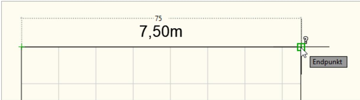
Gemessene Skalierung in Dezimeter (1 Zeichnungseinheit = 1 Dezimeter)
